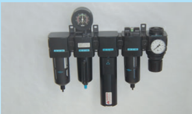
Luftaufbereitung für optische Instrumente mit Vorfilter, Feinstfilter mit Differenzdruck-Manometer, Membrantrockner, Aktivkohlefilter und Druckregler.
