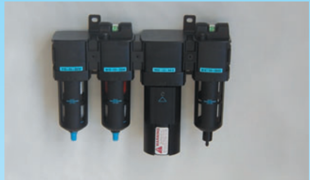
Luftaufbereitung einer Laser-Kunststoffschneidemaschine mit Vorfilter, Feinstfilter, Membrantrockner und Aktivkohlefilter.
