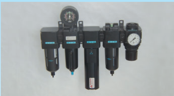
Luftaufbereitung für optische Instrumente mit Vorfilter, Feinstfilter mit Differenzdruck-Manometer, Membrantrockner, Aktivkohlefilter und Druckregler.
